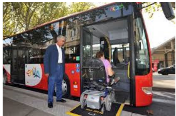
Un bus dont le plancher est à +/- 32 cm présente avec un quai ou trottoir une lacune verticale de +/- 17 cm ; elle peut être rachetée par une lame à commande électrique qui efface aussi la lacune horizontale et permet l'autonomie
