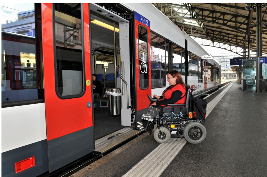
CFF embarquement en autonomie grâce au plain-pied et au dispositif « comble-lacune » fait le bonheur des pmr et, par ailleurs, sécurise tous les usagers
