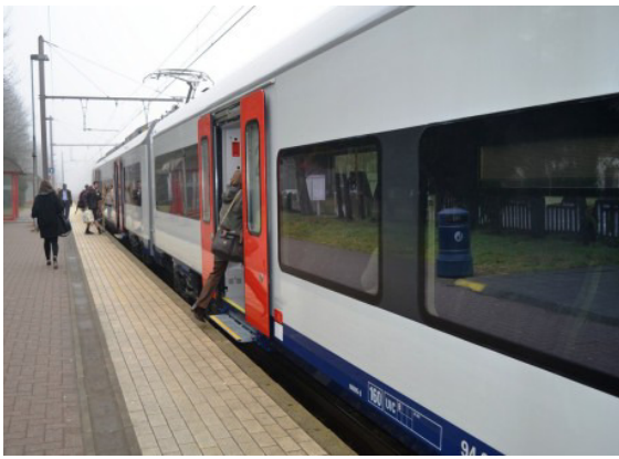
Le Desiro présente une lacune verticale de 50 cm devant un quai bas (illustré) La lacune horizontale est de 30 cm. Un marchepied trop étroit (18 cm) est peu engageant.
