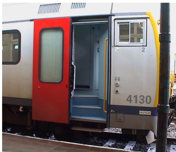
Dernière génération des Autorails de la SNCB (AR41) 4 marches à gravir pour atteindre le plancher situé à 1m20 au-dessus du rail (Athus)
